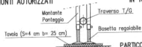
SEZIONE TRASVERSALE C-C DEL PASSO CARRAIO IN TUBI E GIUNTI AUTORIZZATI
