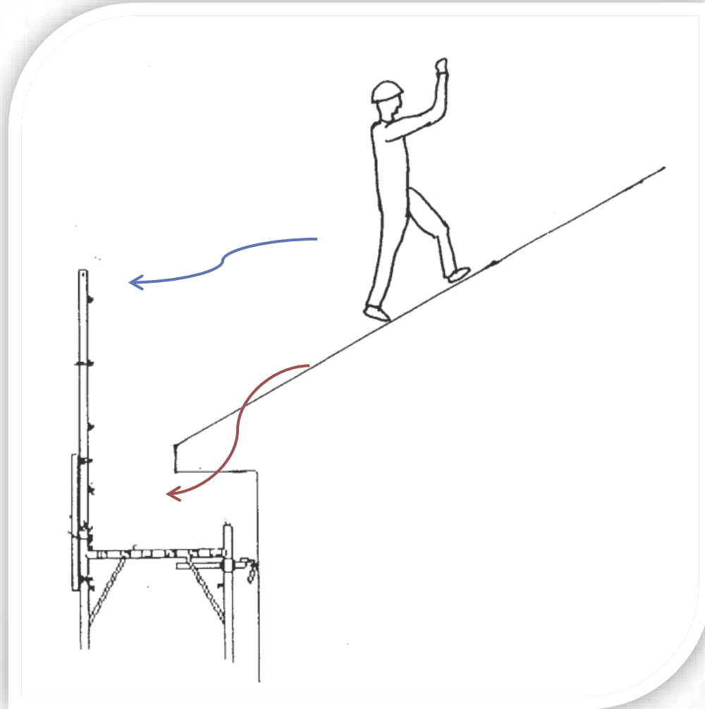
Lavoratore in caduta lungo il pendio di una copertura
